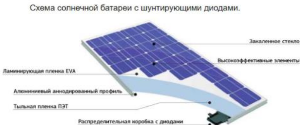
Рис. 3. Устройство монокристаллических солнечной панели.
