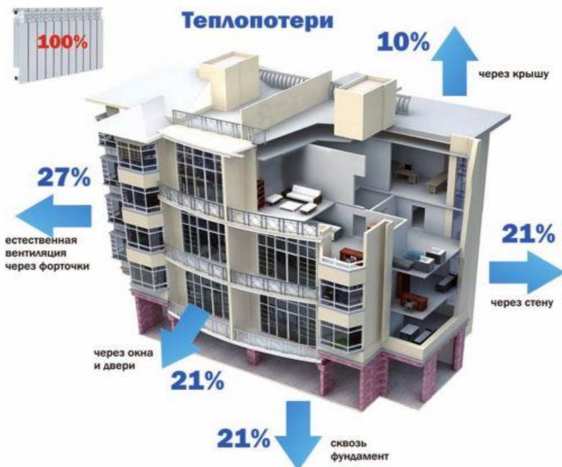
Рисунок 1. Теплопотери в здании
